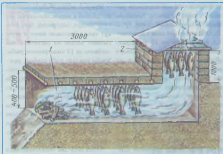
Рис. 5. Коптильня стационарная: 1 — дымоход; 2 — широкая труба.
